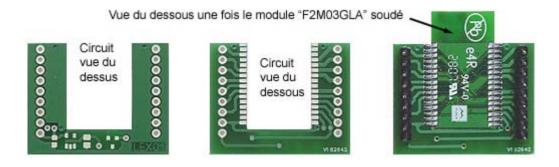
Note: Si vous utilisez le module uniquement dans le cadre d'une communication de données série sans contrôle de flux (et sans avoir recours aux port d'entrées / sorties du module « F2M03GLA », seul les 8 ponts de soudures ci-dessous avec le marquage en rouge seront nécessaires – Les autres connexions peuvent restées non câblées).
