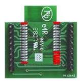
Terminez le câblage de la platine par le montage des 2 rangées de connecteurs mâles au pas de 2,54 mm.
