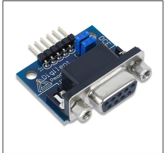
**Schéma de câblage : Il faut deux schémas identiques (un pour l'émetteur et un pour le récepteur). Au niveau des connecteurs DB9 des modules Pmod, relier les masses et croiser les lignes Rx et Tx.**
