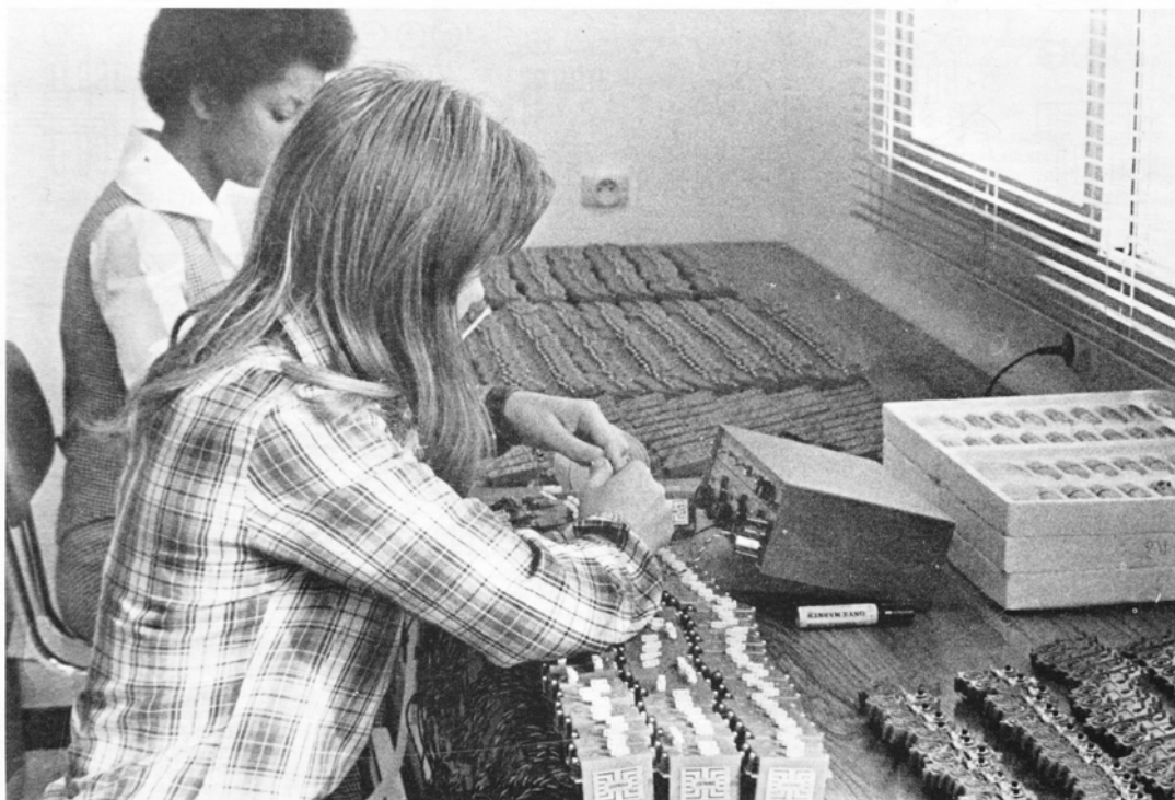
Le montage et le banc de réglage des servomoteurs Lextronic
